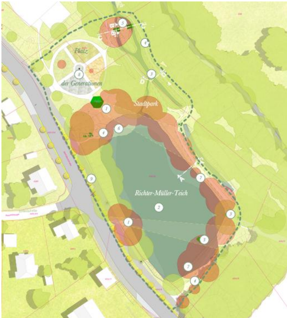
Abb.: Entwurfsplanung der Firma sLandArt zur Neugestaltung des Richter-Müller-Teichs und des Platzes der Generationen. Besonders wichtig ist es, die Sicht- und Wegebeziehungen wiederherzustellen, den Teich zu entschlammen und wasserbauliche Werke zu ersetzen oder zu sanieren.
