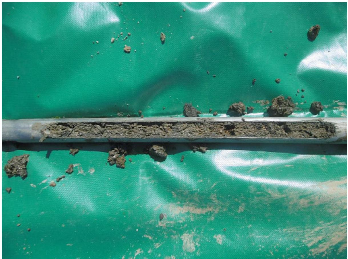
Bild 5: Fläche MI1, Mittelkies, sandig, schluffig, Verwitterungszone bei ca. 4 m.
