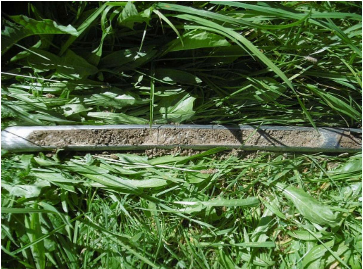
Bild 6: Fläche MI2, Grobsand, schwach schluffig, Verwitterungszone, bei ca. 2 m.
