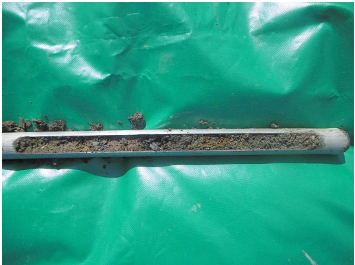
Bild 4: Deponiematerial von Schicht 2, schluffig-sandig, mit Fremdstoffen.
